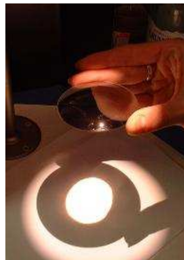
Abbildung 5: Die beim Blick durch die Zeisslampe sichtbar werdenden Schatten deuten auf einen nicht gleichmäßigen Abtrag hin. Der Polierprozess muss fortgesetzt werden. Die Mathematik kann helfen, an dieser Stelle den Produktionsprozess zu verkürzen
